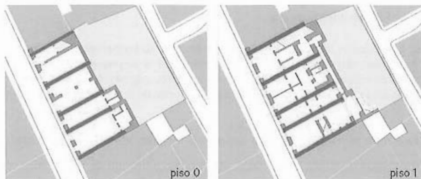
Fig. 13. Plantas do piso 0 e 1, com paredes-mestras assinaladas a vermelho, in Mariana, 2007, pág. 106.
