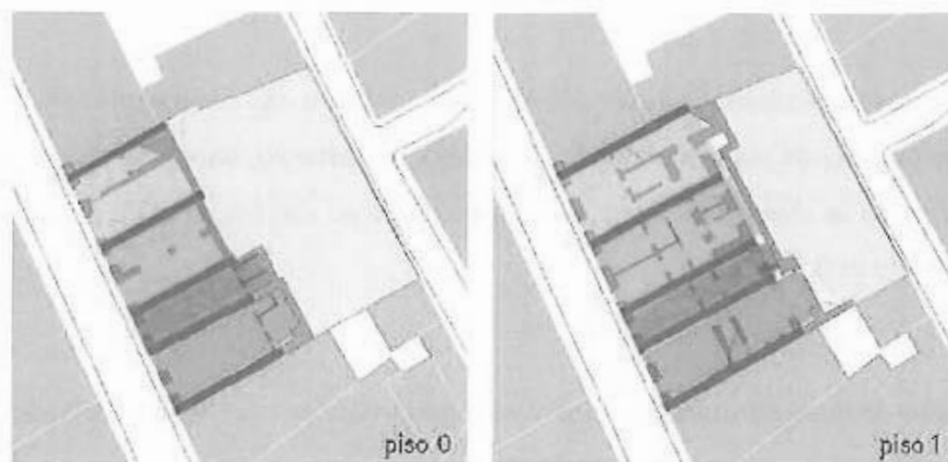
Fig. 13. Plantas do piso 0 e 1, com paredes-mestras assinaladas a vermelho, in Mariana, 2007, pág. 106.
